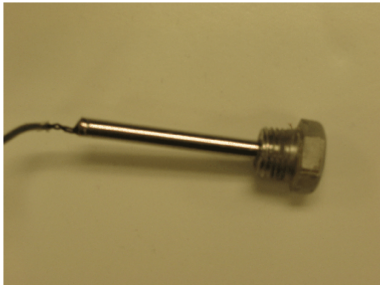
Figure 2. Thermistor probe un-threaded from the meter body / Sonde à thermistance non filetée au corps du compteur
