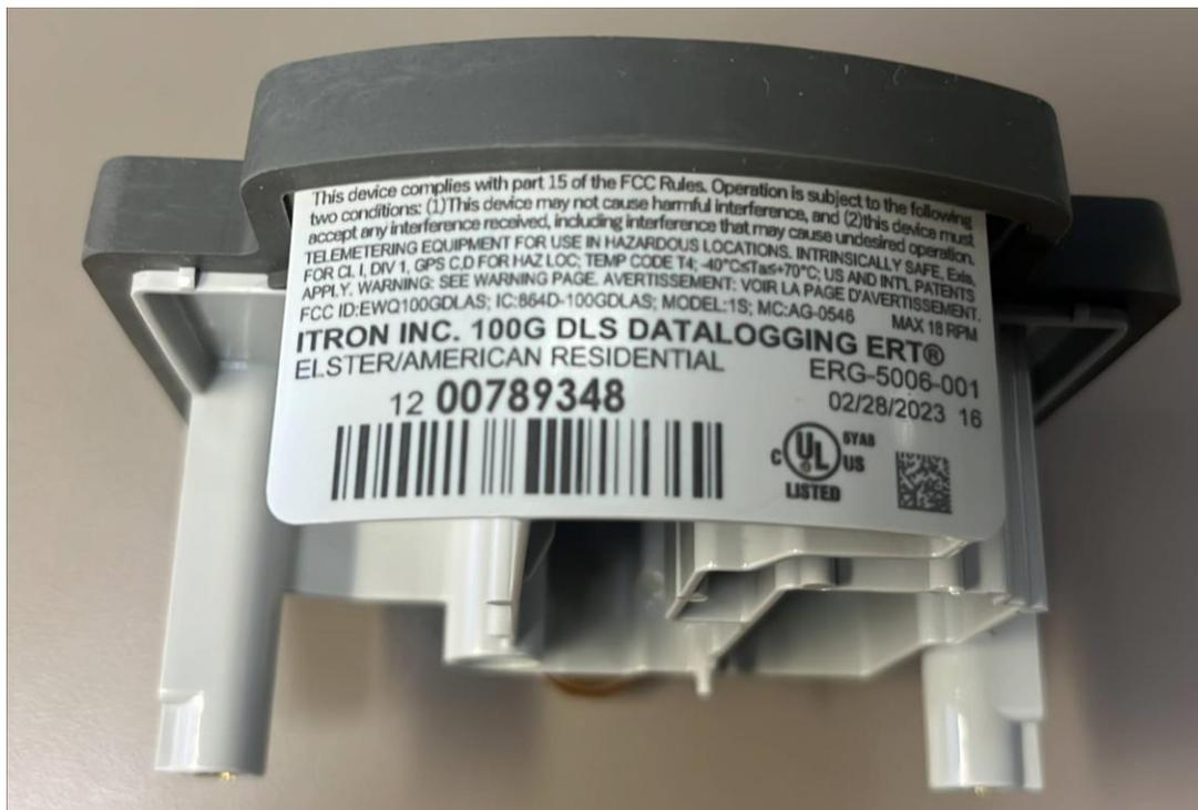
Example of laser etched markings for 100G / Exemple de marquages gravés au laser pour 100G
