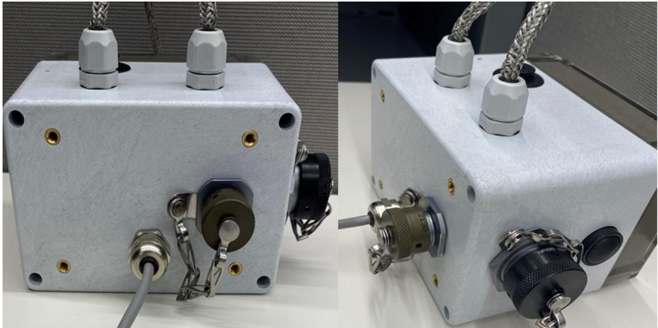
Figure 1: AdEM PTZ model without the pressure transducer / Modèle AdEM PTZ sans le transducteur de pression
