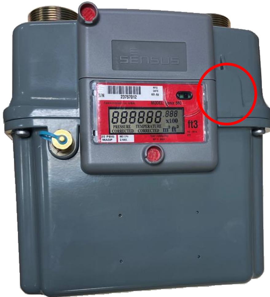
Figure 2: Photo showing meter casing with no plug and non-removable thermistor. / Photo montrant le boîtier du compteur sans bouchon et avec une thermistance inamovible.
