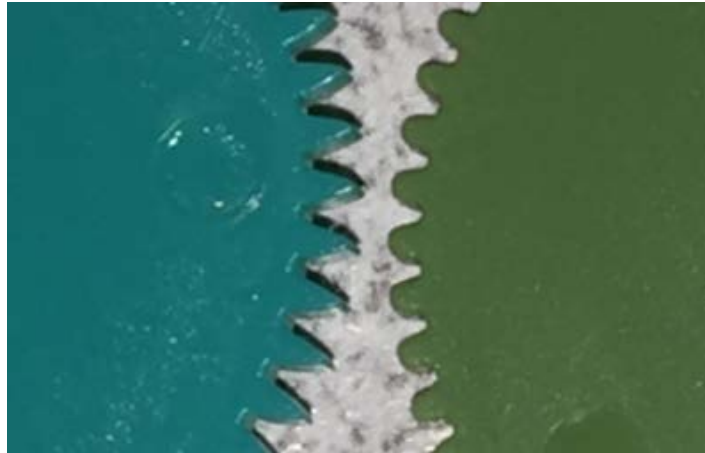
Figure 1 – Triangular teeth, old style (left); Involute teeth, new style (right) / Dents triangulaires, style ancien (à gauche); Dents involutés, style nouveau (à droite)
