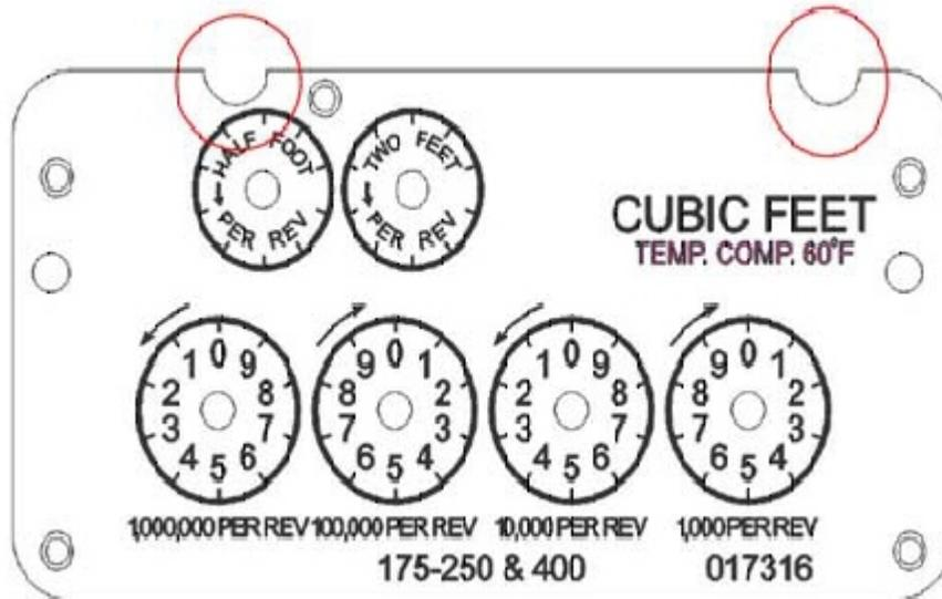
New dial index plate: Models 675A, 800A and 1000A commercial meters. / Nouvelle plaque à indicateurs de compteurs pour les modèles de compteurs commerciaux suivants : 675A, 800A et 1000A
