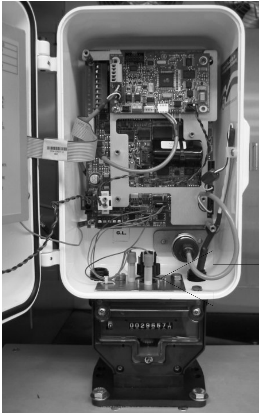
Figure 2: UMB with two switches, as installed in Mini-AT/ UMB avec deux commutateurs installés dans le Mini-AT
