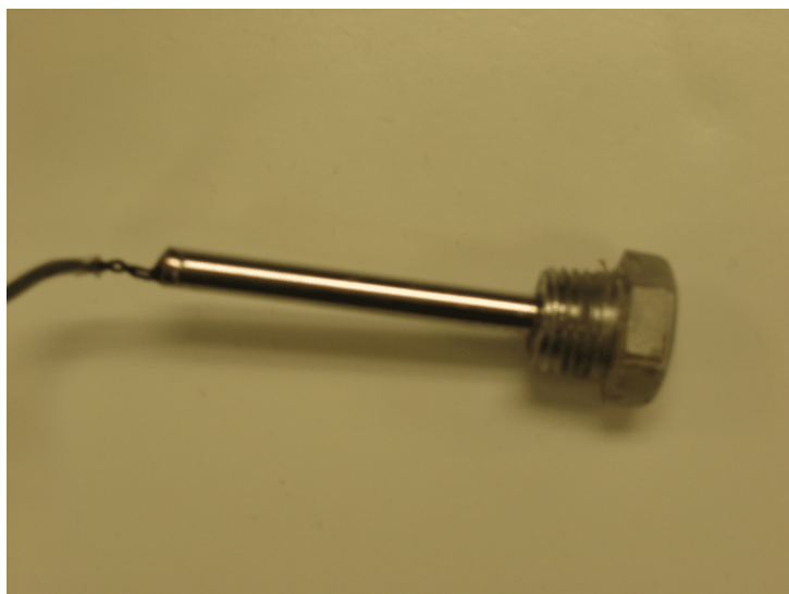
Fig. 2 : Thermistor probe un-threaded from the meter body/Sonde à thermistance dévissée du corps du compteur
