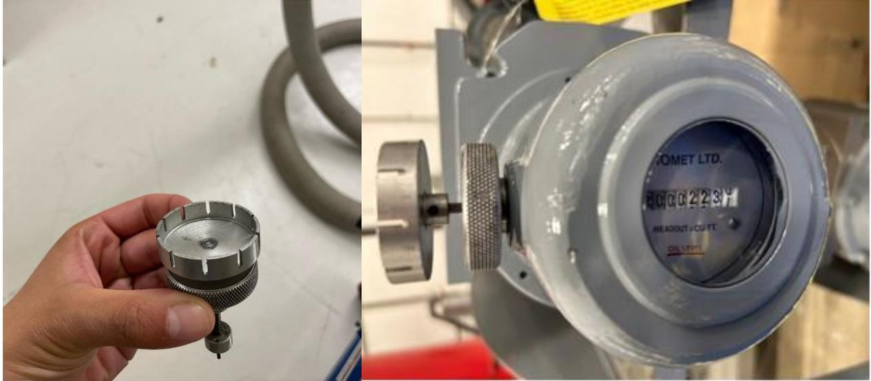
**Figure 1: Slotted disk adapter / l'Adaptateur de disque à fentes**
