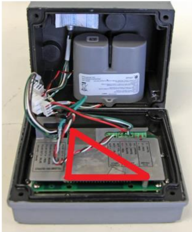
Figure 10: The battery of DI-T is displayed in an exposed enclosure on the upper part, while the red line indicates the sealing of the PCB / La batterie du DI-T est présentée dans un boîtier exposé sur la partie supérieure, tandis que la ligne rouge indique le scellement du circuit imprimé.
