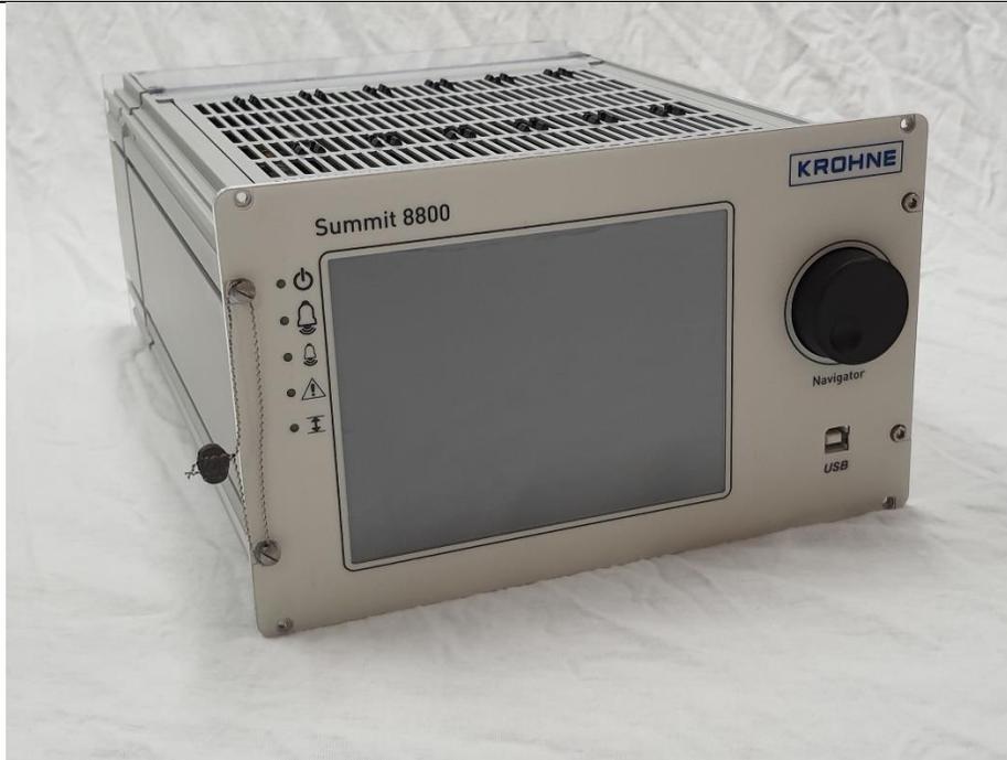
**Figure 3. Summit 8800 Front Panel Sealing Configuration / Configuration de l'étanchéité du panneau frontal du Summit 8800**
