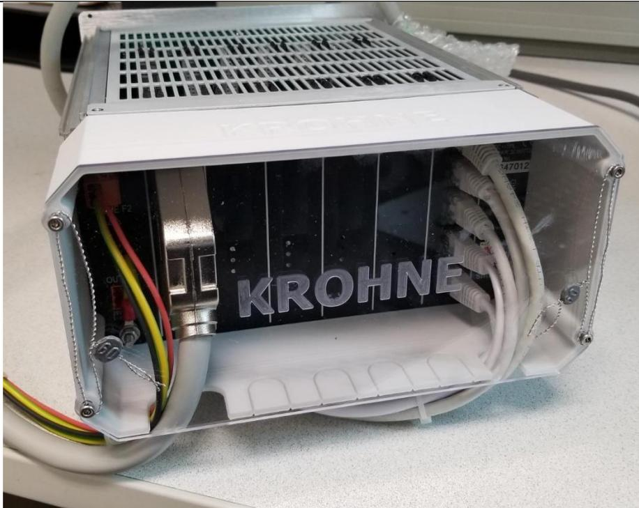
**Figure 4. Summit 8800 Rear Panel Cover Sealing Configuration / Configuration de l'étanchéité du couvercle du panneau arrière du Summit 8800**
