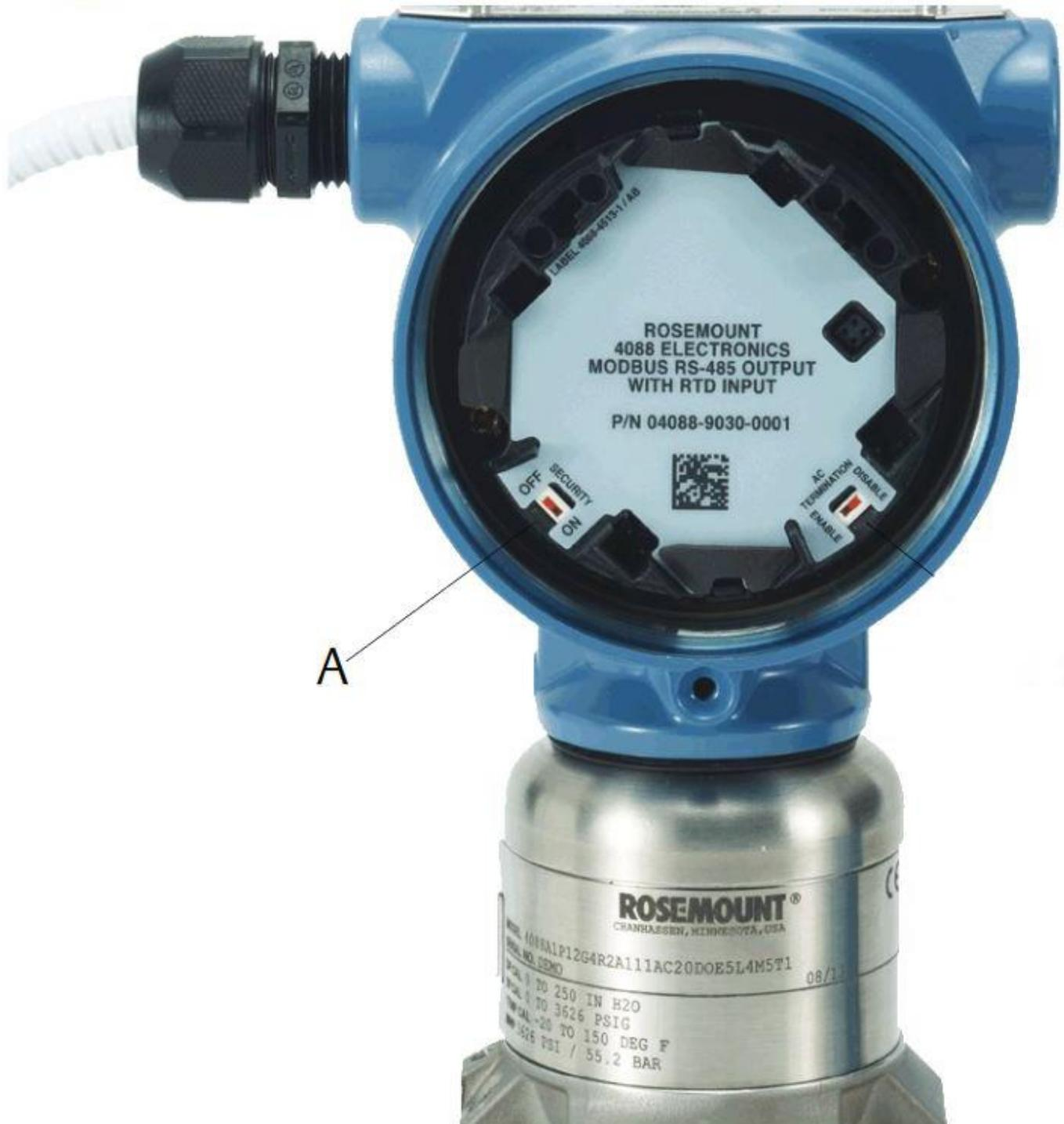
Figure 1: Security switch identified by "A"/ Interrupteur de sécurité identifié par "A".
