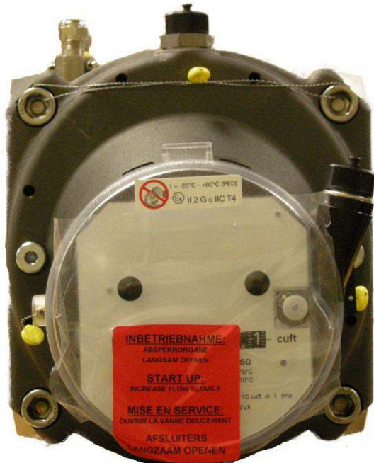
Figure 1 : Sealing Locations for the RABO meter body marked by yellow tabs / Figure 1 : Points de scellage du corps du compteur RABO indiqués par des attaches jaunes
