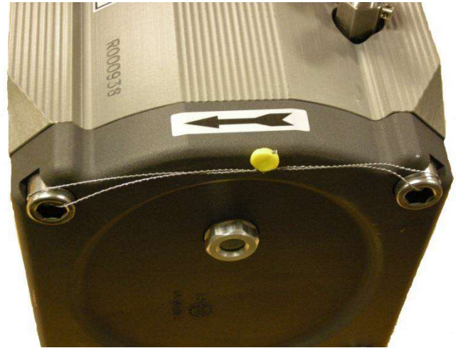
Figure 1 : Sealing Locations for the RABO meter body marked by yellow tabs / Figure 1 : Points de scellage du corps du compteur RABO indiqués par des attaches jaunes
