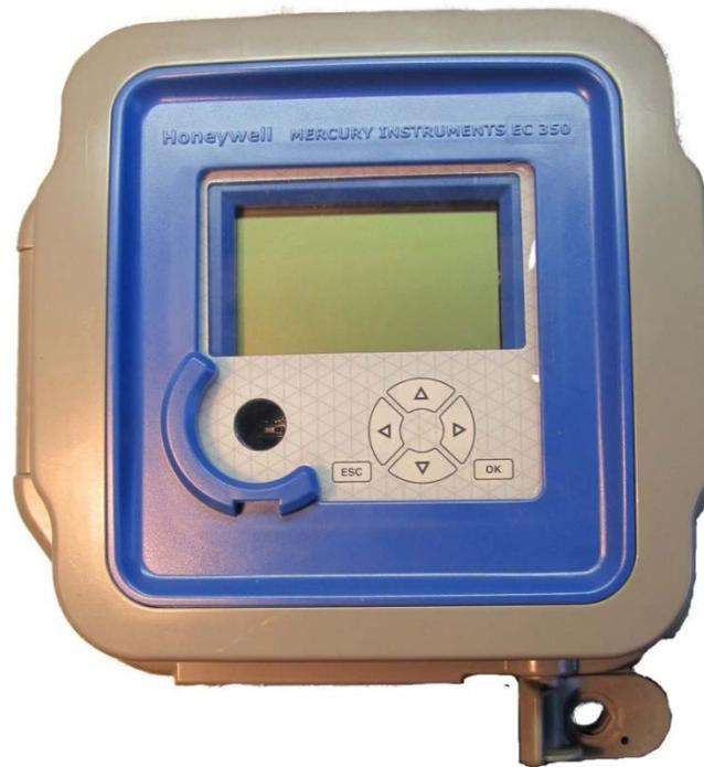
**Figure 1.** External view of EC 350 with door hasp (bottom right corner) / Vue extérieure du EC 350 avec loquet de porte (coin inférieur droit)
