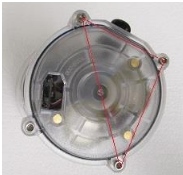
Figure 5 : Sealing the end cover for the battery compartment \ Scellage du couvercle d'extrémité pour le compartiment de la pile
