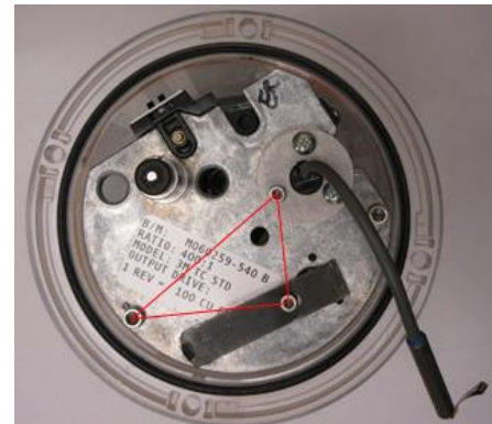
Figure 6 : Sealing the register compartment on the ES3 \ Scellage du compartiment de l'enregistreur sur le modèle ES3
