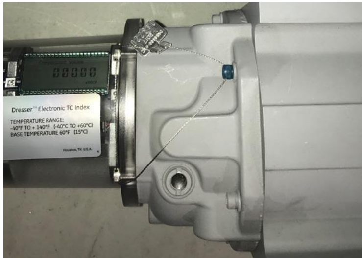
Figure 9. Sealing the conversion device to Roots series "B" meters / Scellement du dispositif de conversion pour les compteurs Roots de la série « B »
