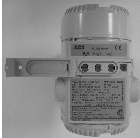
Fig. 7: XMV multivariable transducer: configuration keys / Transducteur multivariable XMV : touches de configuration
