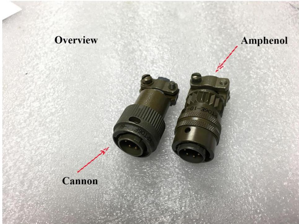
**Figure 4 :** Connector Types / Types de connecteurs
