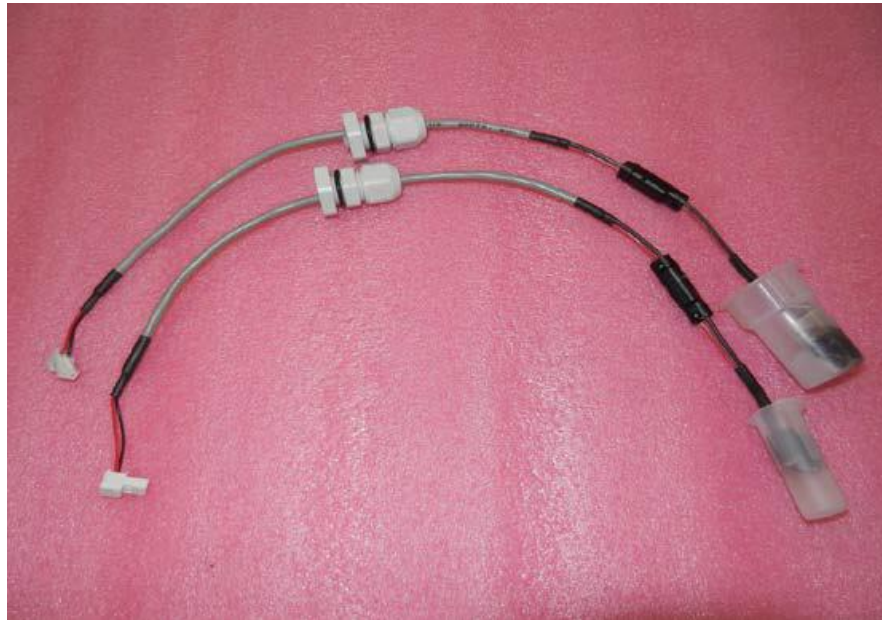
Figure 15: 46-124-10/46-124-20 (top) and 46-124-10/49-124-20 (bottom) wiegand sensor assemblies / 46-124-10/46-124-20 (en haut) et 46-124-10/49-124-20 (en bas) ensembles de capteurs wiegand
