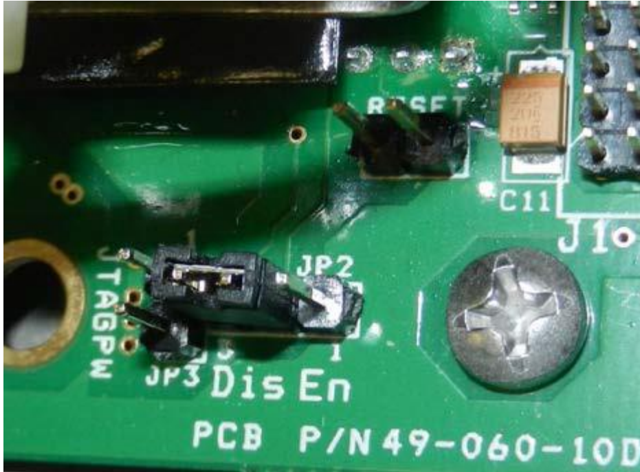
Figure 5a: Program switch in “Dis” (disabled) position / Interrupteur de programme en position "Dis" (désactivé).
