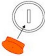
Figure 3. Padlockable Quarter-turn Latch and the Sealing Arrangement / Dispositif de scellage verrouillable par un loquet quart de tour à cadenas
