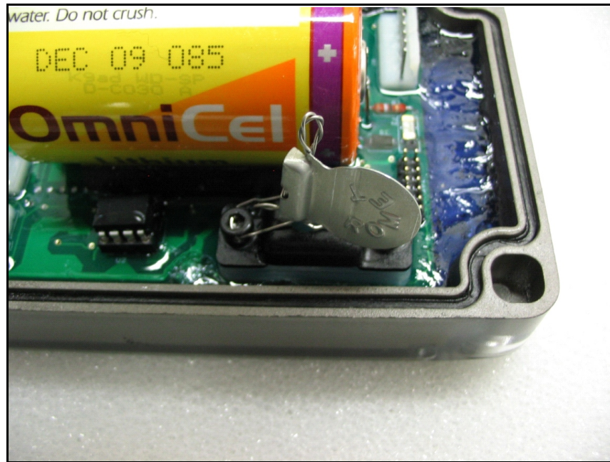
Figure / Image 4 : Sealing of the program switch ( Scellage de l'interrupteur de programmation)
