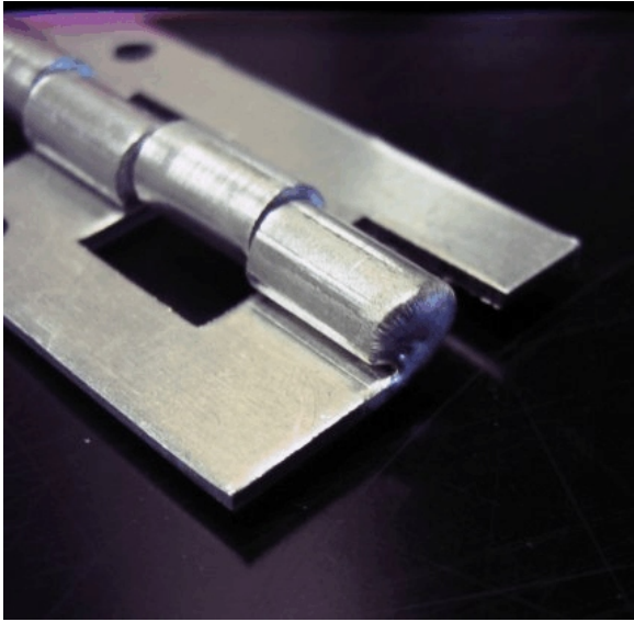
Figure 2. Sealing the hinge pin /Scellage de la broche de la charnière
