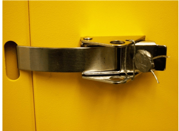
Figure 3. Sealing the quick-release latch /Scellage de l'attache à ouverture rapide
