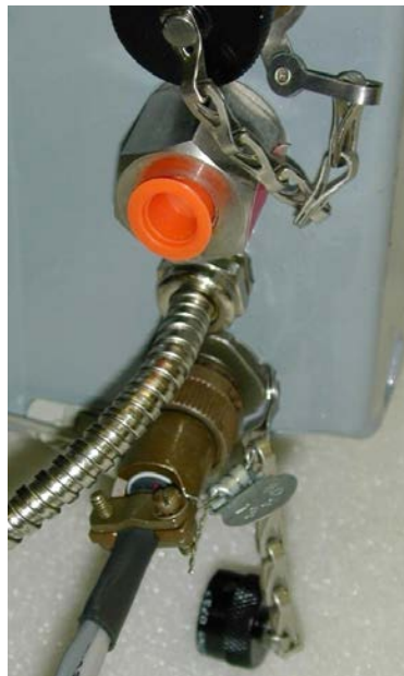
Figure / Image 3 : Sealing of the output pulse cannon connector Scellage du connecteur canon de sortie d'impulsion
