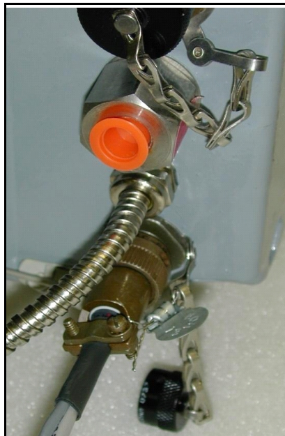
Figure / Image 3 : Sealing of the output pulse cannon connector Scellage du connecteur canon de sortie d'impulsion
