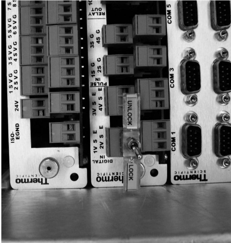
Fig. 3 : Security Switch on Combo Board / Interrupteur de sécurité sur la carte combo
