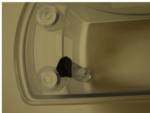
Figure 6. Provision for sealing access to the IR LED on ORION series domestic models / Mécanisme pour protéger l'accès à la DEL IR des appareils résidentiels Orion
