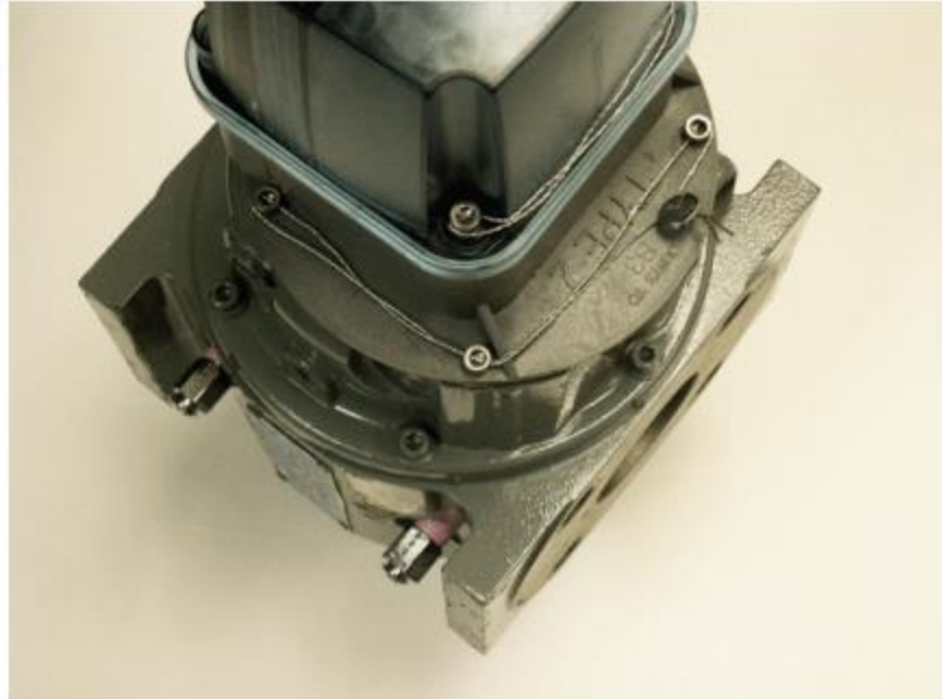
Figure 5: Sealing the adapter plate to the meter body/ Sceller la plaque d'adaptation au corps du compteur
