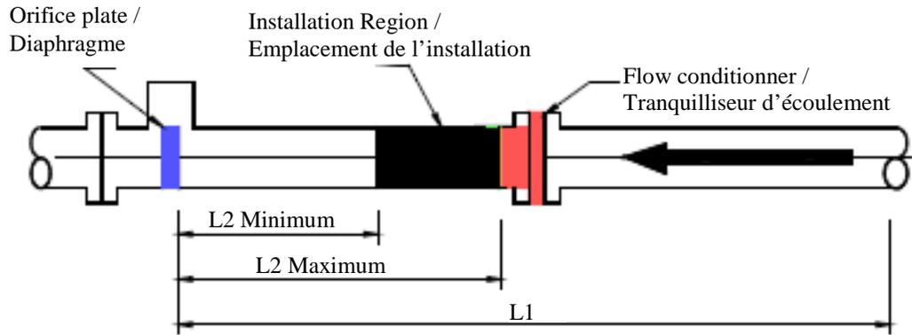
**Figure 4.** Installation of Flow Conditioner / Installation du tranquilliseur d'écoulement.
