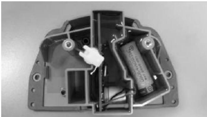
**Fig. 14: 100G Datalogging ERT, Part No. ERG-5002-005 (Front View) / N° de pièce ERG-5002-005 (Vue de face), Note: Rear view is the same as ERG-5000-005 / Remarque : Vue arrière est la même de ERG-5000-005**
