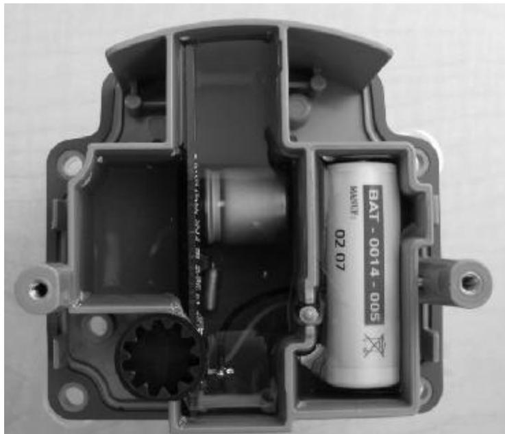
**Fig. 16: 100G ERT, Part No. ERG-5000-002 (Front View) / N° de pièce ERG-5000-002 (vue de face), Note: Front view is the same as ERG-5000-003 and ERG-5000-004 / Remarque : Vue face est la même de ERG-5000-003 et ERG-5000-004**
