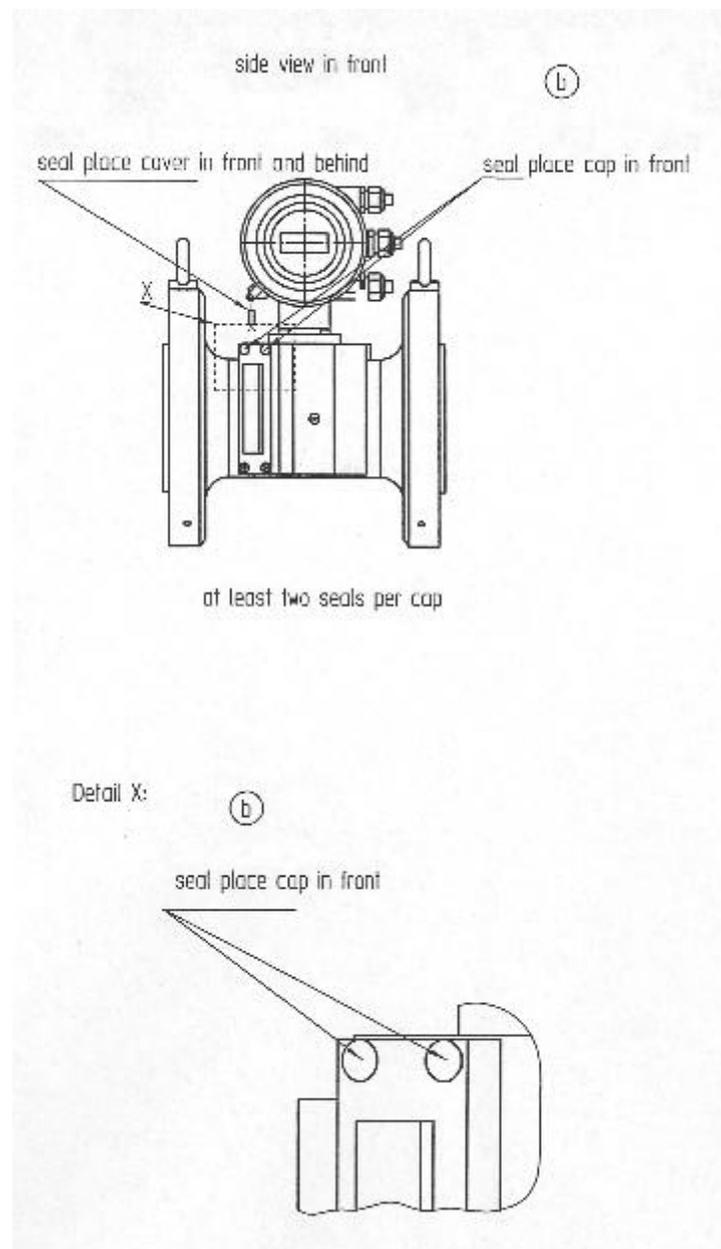
**Fig. 6 : Sealing of Transducers, view 1 of 2 / Scellage des transducteurs, vue 1 de 2**
