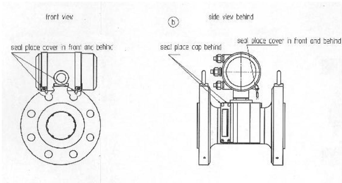
**Fig. 7 : Sealing of Transducers, view 2 of 2 / Scellage des transducteurs, image 2 de 2**
