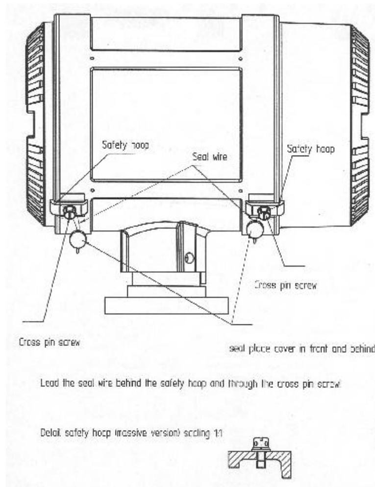
**Fig. 4 : Sealing of SPU covers / Scellage des couvercles du SPU**
