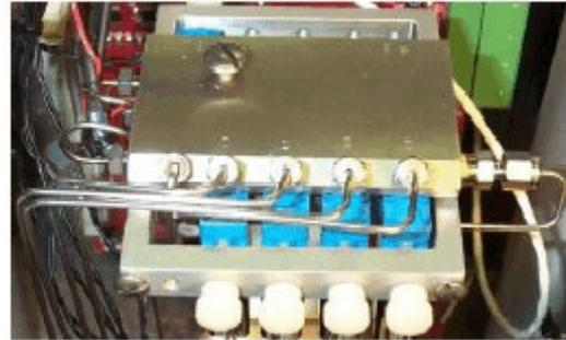
**Figure 3 (left/gauche):** Thermal conductivity detectors / Détecteurs à conductivité thermique
