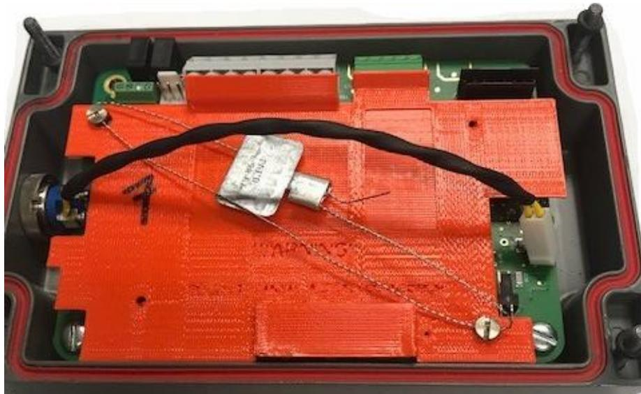
**Fig. 4 : Read/Write Switch + Terminals Conventional Sealing / Commutateur de lecture/écriture + terminaux scellage conventionnel**
