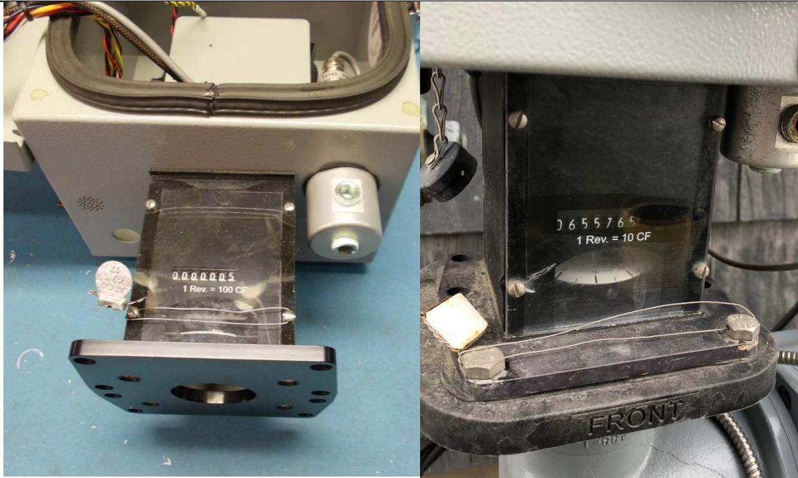
**Figure 4 :** Wire sealing on GASMicro mechanical index / Scellage de fil sur GASMicro index mécanique
