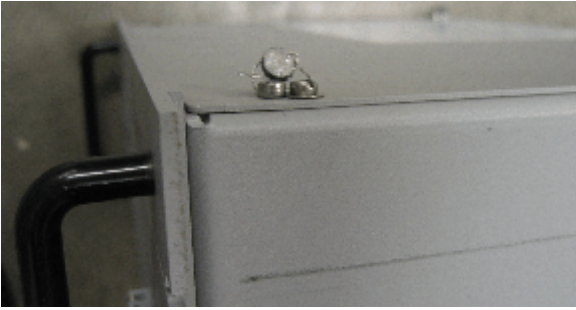
Figure 9 Sealing provision for rackmount enclosure / dispositifs de scellage pour le boîtier sur bâti
