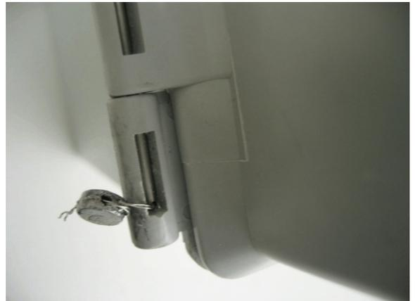
**Figure 10.** 1131C Hinge Pin Sealing / Scellage de la tige de la charnière du modèle 1131C
