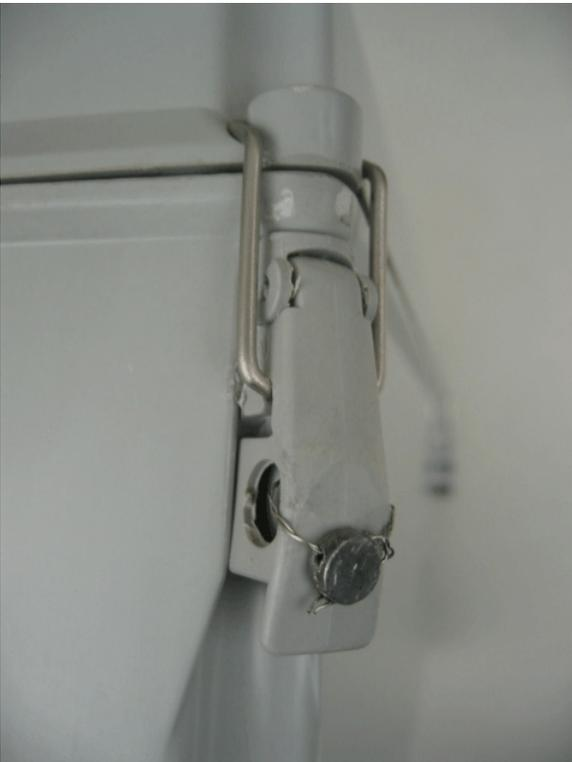
**Figure 11.** 1131C : Latch Sealing / Scellage du loquet du modèle 1131C
