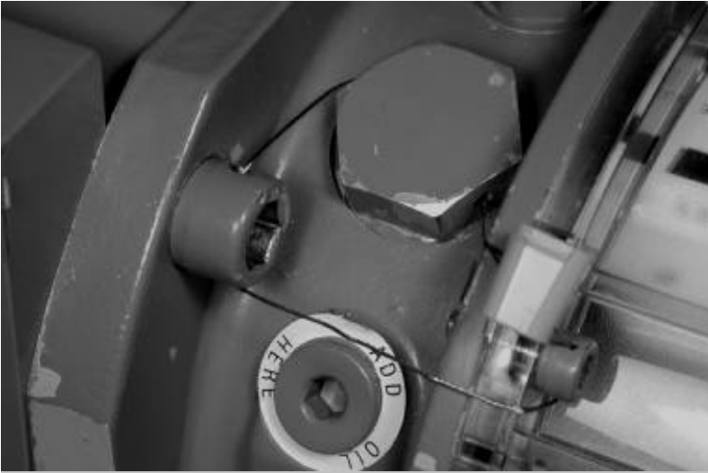
Figure 4: Sealing of the CMTC module to RPM series meter/ Scellage du module CMTC au compteur de la série RPM
