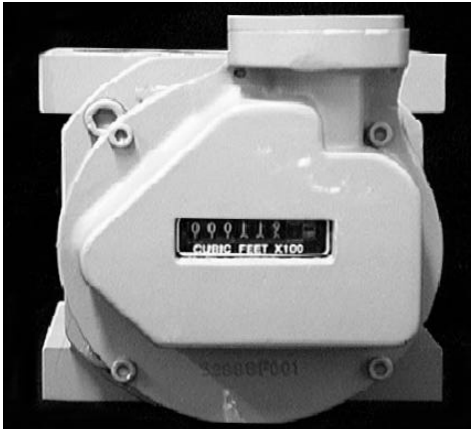
Figure 6: Original RPM series meter and register / Compteur original de la série RPM et enregistreur
