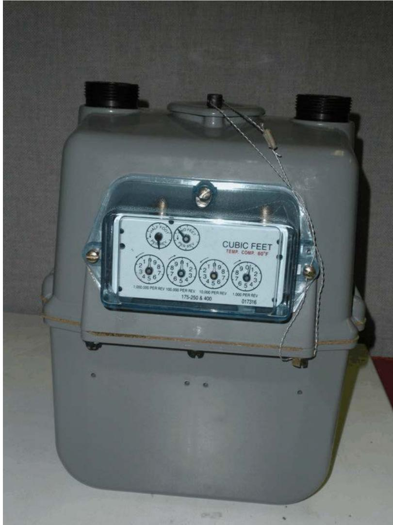
**Fig. 17:** A conventional type seal / un scellage de type classique
