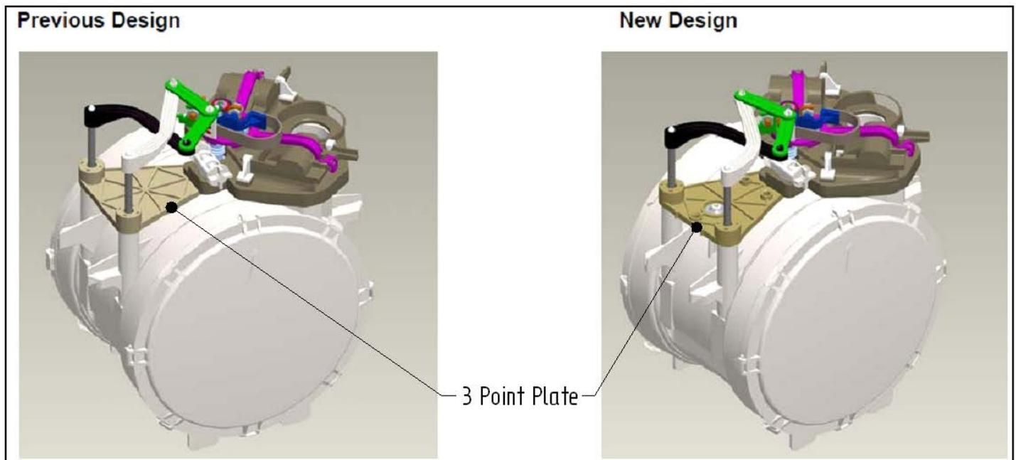
**Fig. 19 : 3 point plate / Une plaque à trois points**
