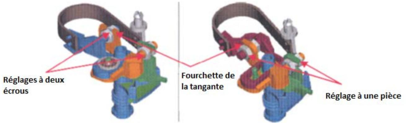
**Fig. 10 :** TC adjustment mechanism / Mécanisme de réglage, CT
