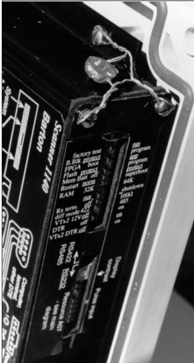
Figure 6 Sealing Provision / Disposition de scellement
