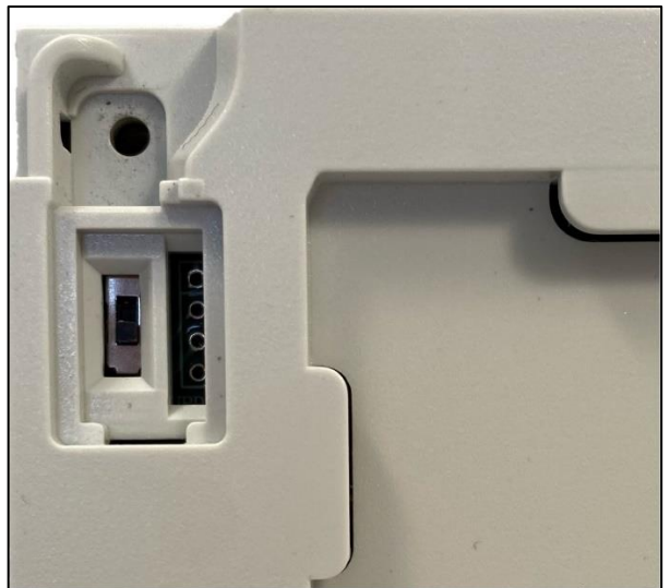
Programming switch / Commutateur de programmation
