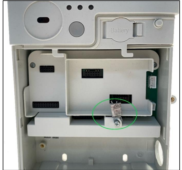
Meter terminals seal / Le sceau pour les bornes du compteur
