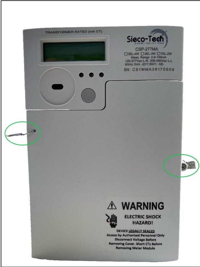
Two utility seals / Deux sceaux d'installation
