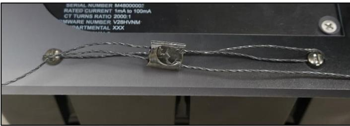
Flush Mount Enclosure Sealing / Scellage du boîtier encastré
