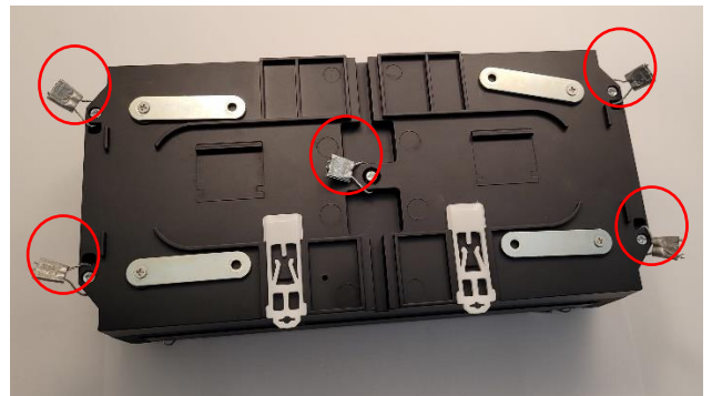
Figure 2 – Five metrology seals on the underside of the metering module. / Cinq sceaux métrologiques sur le dessous du module de compteur.
