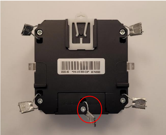
Figure 4 – 1 installation seal on the terminal cover on the underside of the display module. / 1 sceau d'installation sur le cache-borne sur le dessous du module d'affichage.
