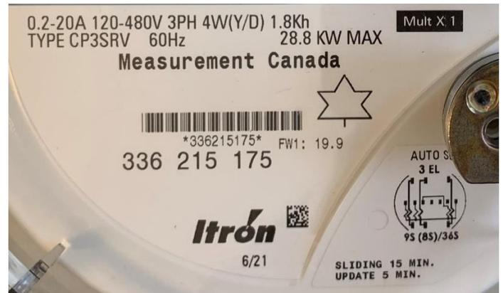
**Figure 2 : Nameplate / Plaque signalétique**
