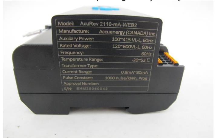
Side View and nameplate location / Vue de côté et emplacement de la plaque signalétique
