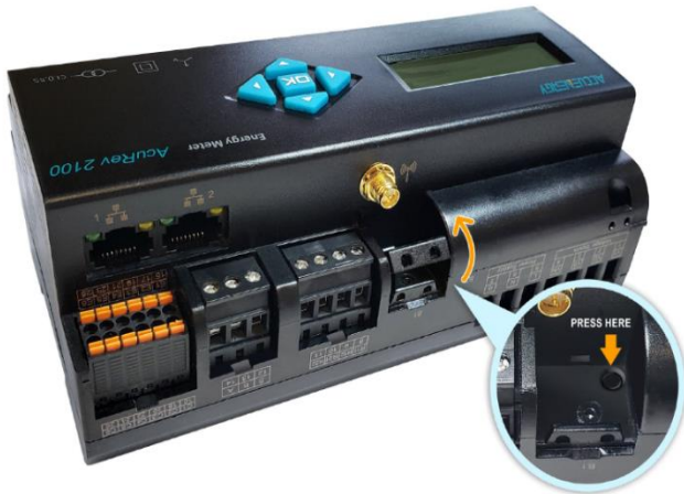
Location of the software programming button / Emplacement du bouton de programmation du logiciel
