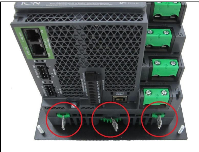
Figure 2: The underside of the meter with the three metrological seals required to prevent separation of the various modules. / La face inférieure du compteur avec les trois sceaux métrologiques nécessaires pour éviter la séparation des différents modules.
