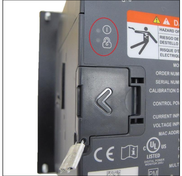
Figure 3: Sealed programming switch door below power and programming switch LEDs. / Porte de l'interrupteur de programmation scellée sous les DEL de marche et d'interrupteur de programmation.
