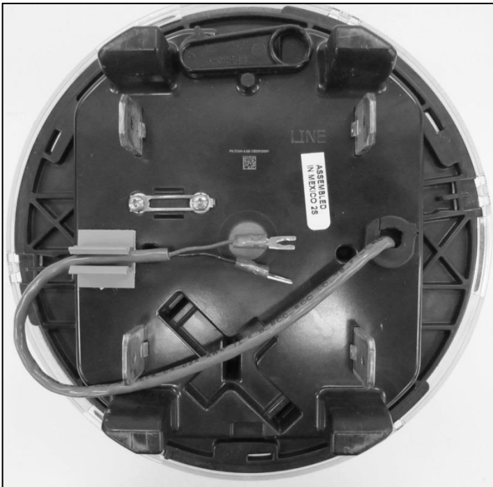
FOCUS AXRe-SD meter with optional real-time rate switching cable / FOCUS AXRe-SD avec un câble optionnel pour le changement du tarif en temps réel
