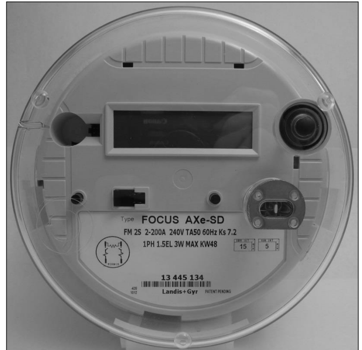
FOCUS AXe-SD with a manual reset switch for the service disconnect / FOCUS AXe-SD avec un commutateur de réarmement manuel pour l'interrupteur-sectionneur
