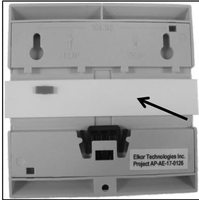
Plastic piece installed on back of meter / Pièce de plastique installée à l'arrière du compteur
