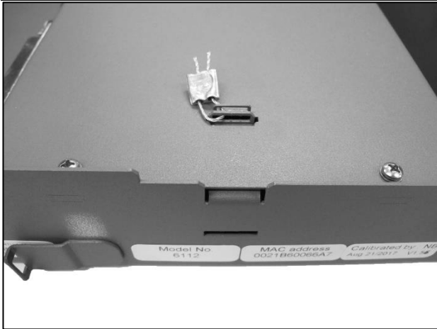
Metrological Sealing Location / Emplacements du sceau métrologique
