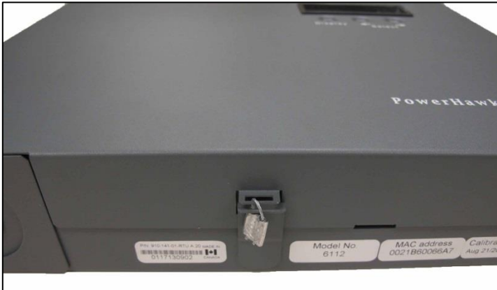
Installation Sealing Location / Emplacement du sceau d'installation
